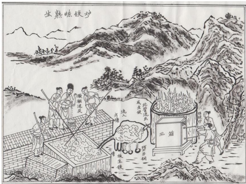
图 3-7 《天工开物》中描绘的炒钢技术
